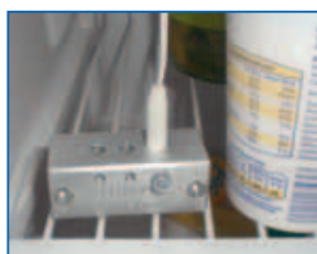
Aluminiumblock verzögert die Ansprechzeit des Fühlers
