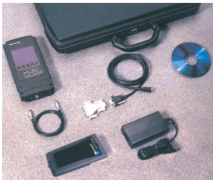
Standardní souprava Sola-Scope 2000™ . K dispozici je celá řada sond a příslušenství.
